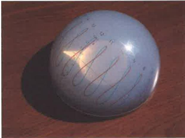
図3 半球型日時計の例
