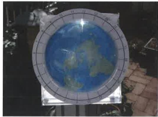
図8 透明な半球を反射面にし、内側の赤道面に正距方位図法で描いた北極を中心にした世界地図を置いたもの
