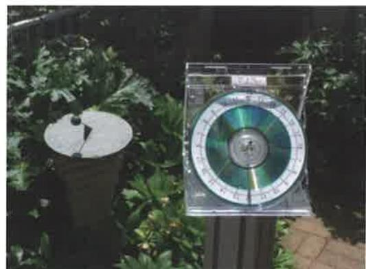
図9 CDディスクの円形グレーティングを利用した日時計
