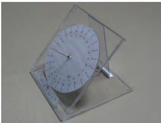
これをCDのケースに入れて、開き角を調節してノーモンが緯度と同じ角度になるように設定すればできあがりです。ケースの中で円板は回転できるので、経度の差による補正や、均時差の補正を行うこともできます。
