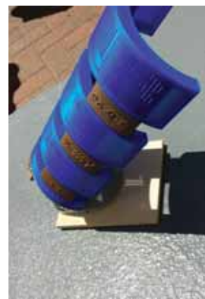
写真7 200 時間をかけて 3D プリンターで印刷したデジタル日時計。PM1 時
